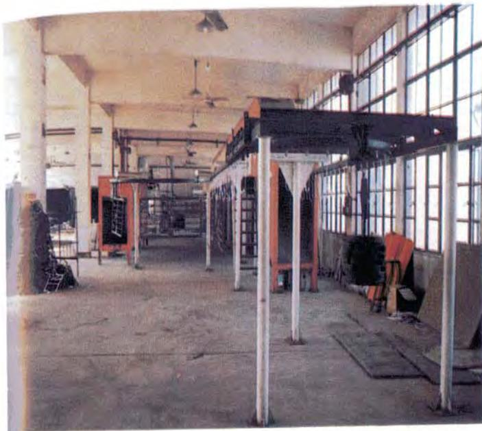
南京金属家具总厂塑料喷涂生产线
