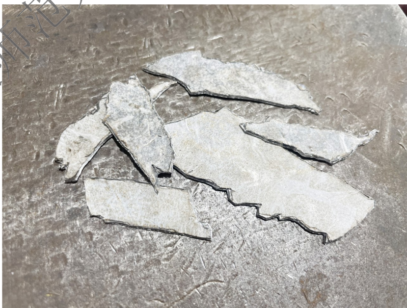
通过凿切技法下样后的铁画部件
