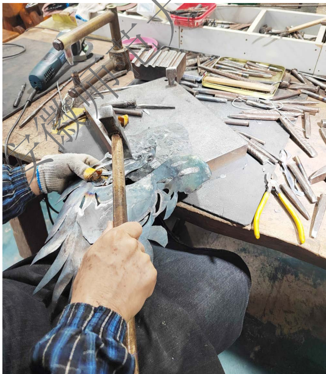
在铁砧上利用手锤对马头进行整形
