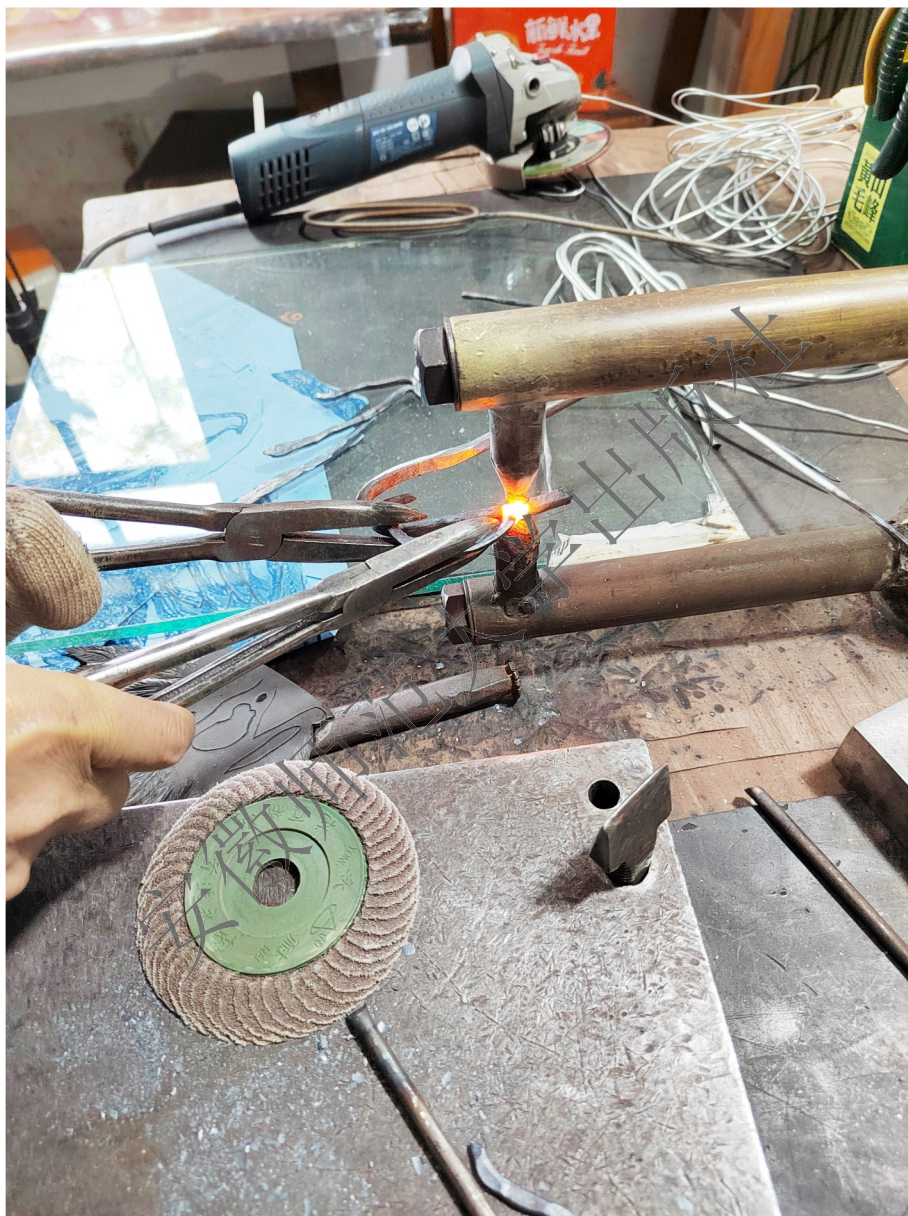
双钳夹住铁件在点焊机上加热
